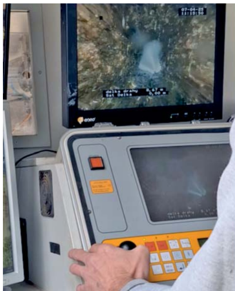
Vysokotlaké čištění a kontrola potrubí
