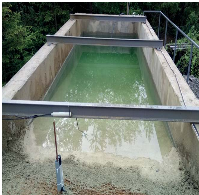
Obr. 5: Experimentální ověření funkčnosti stříkané bentonitové vrstvy bylo provedeno na modelu hráze v reálném měřítku.
