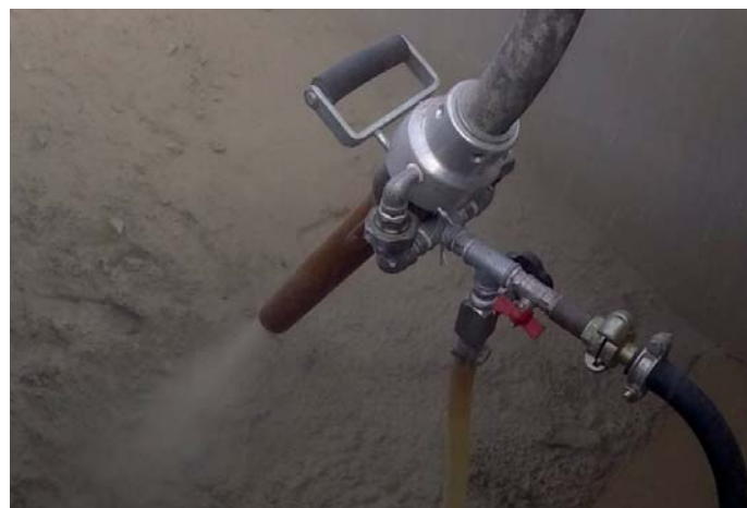
Obr. 4: Experimentální ověření funkčnosti stříkané bentonitové vrstvy bylo provedeno na modelu hráze v reálném měřítku.
