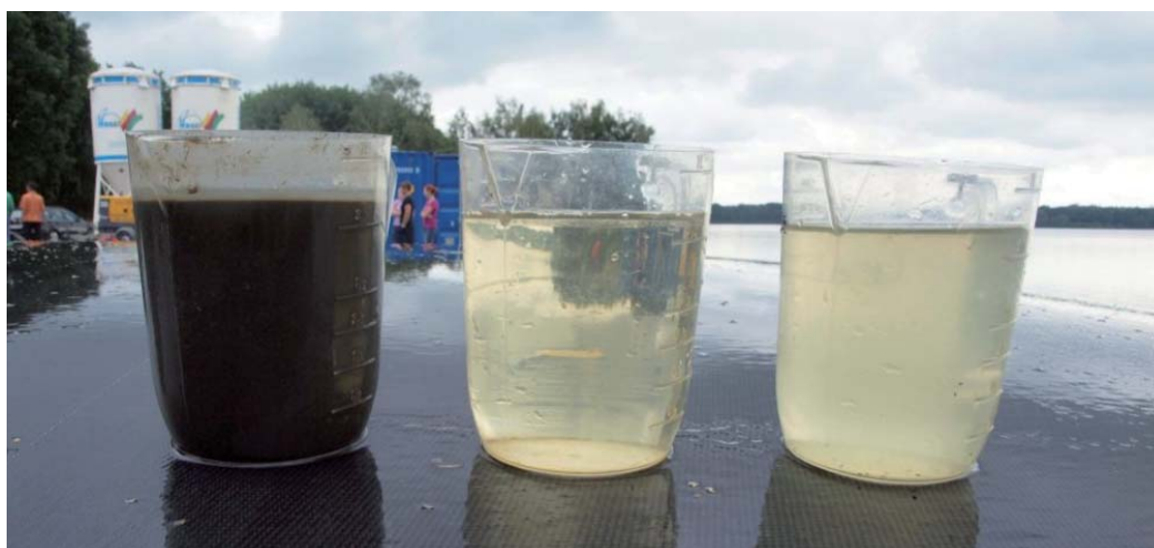
Obr. 3: Vizuální porovnání vody natékající (vlevo) a odtékající z vaků ke konci jejich plnění (prostřední kádina) a vody v epilimniu rybníka Horusického (vpravo).
