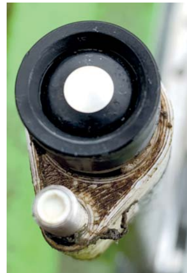
Obr. 2 – Sonda SmonOX – 5 měsíců ve vodě
