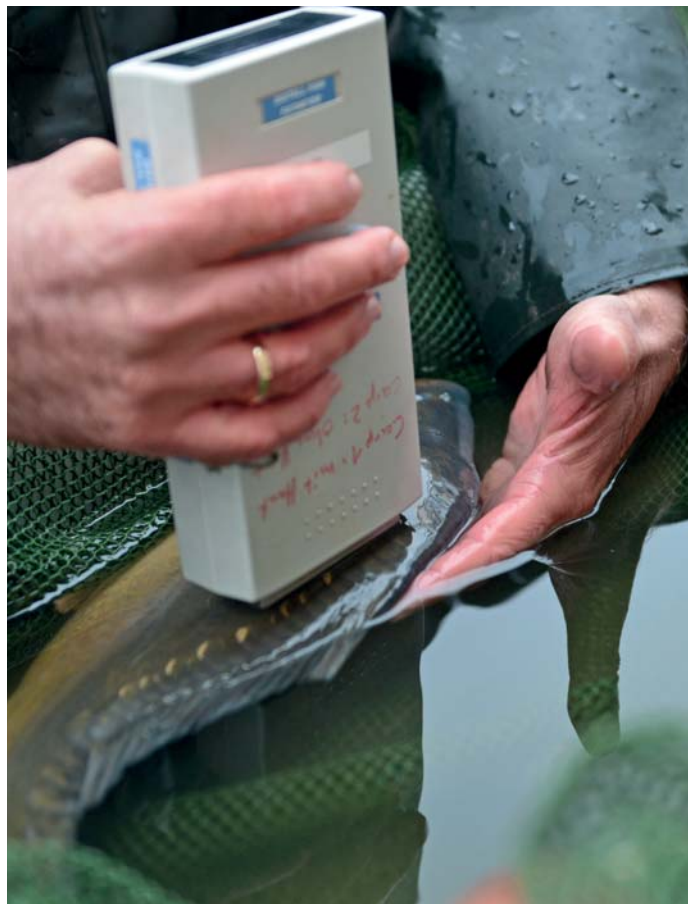
Obr. 4: Měření obsahu tuku na živém kaprovi (Foto: Mila Pavan).
