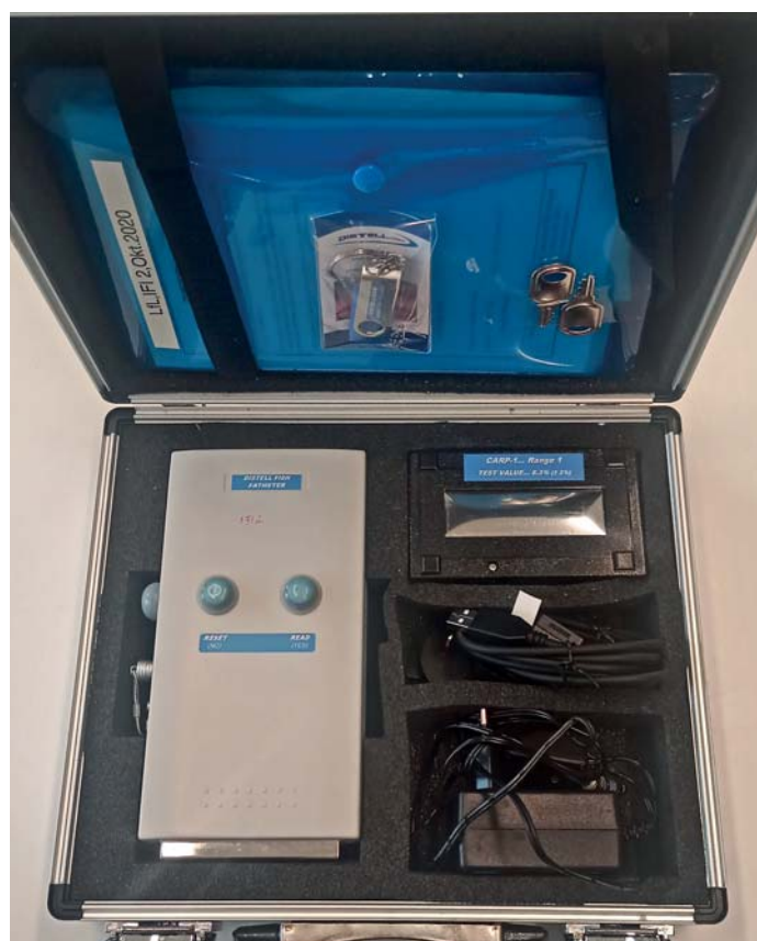
Obr. 1: Přístroj na měření obsahu tuku v praktickém transportním kufříku. (vlevo menší model FFM 992 a vpravo větší model FFM 962).
